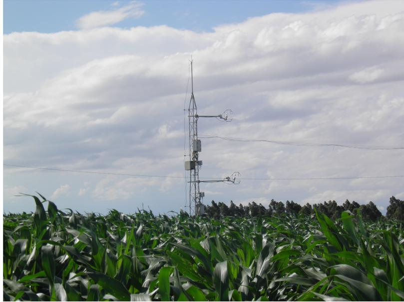
Figura 3.4: Torre micrometeorológica com o sistema de covariância de vórtices instalada no sistema de plantio convencional (PC) no sítio experimental Cruz Alta.
