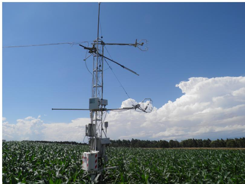
Figura 3.3: Torre micrometeorológica com o sistema de covariância de vórtices instalada no sistema de plantio direto (PD) no sítio experimental Cruz Alta.
