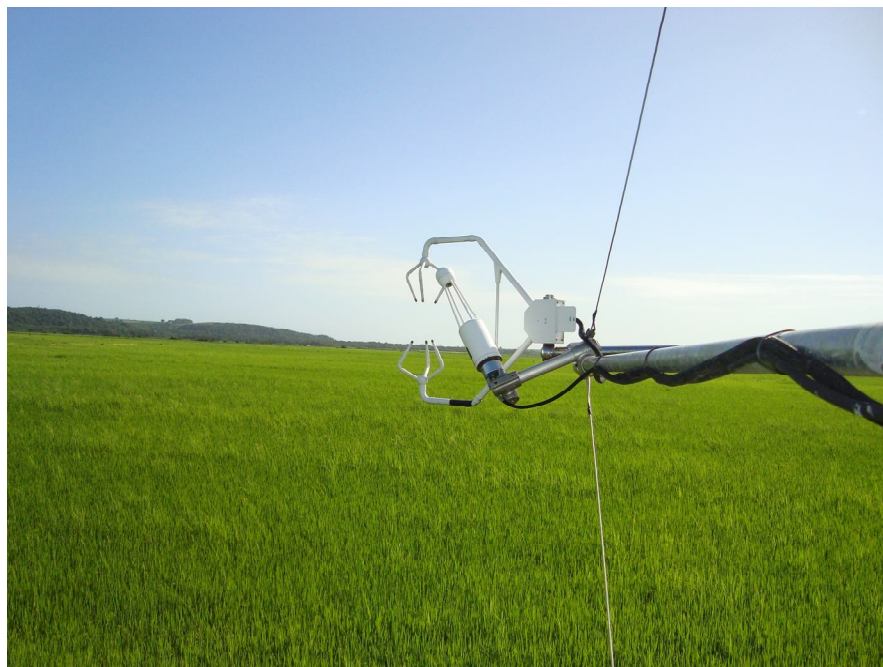
Figura 3.2.3 - Sistema de covariância de vórtices ( eddy covariance ): anemômetro sônico e analisador de gás de caminho aberto – sítio de Cachoeira do Sul.
