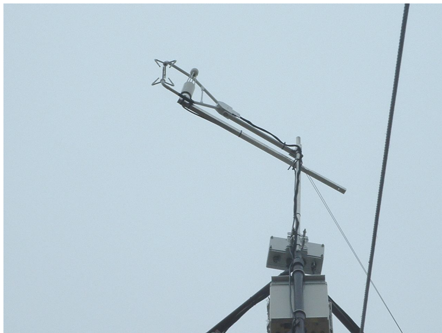
Figura 3.1.3 - Sistema de covariância de vórtices ( eddy covariance ): anemômetro sônico e analisador de gás de caminho aberto – sítio de Paraíso do Sul.
