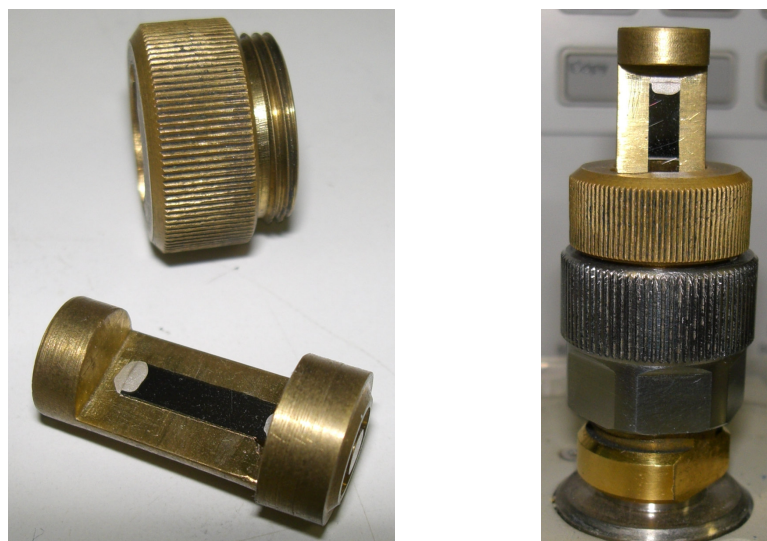
Figura 3-18. Cavidade de microondas do tipo “strip line” usada como porta-amostras nos experimentos de MI .
