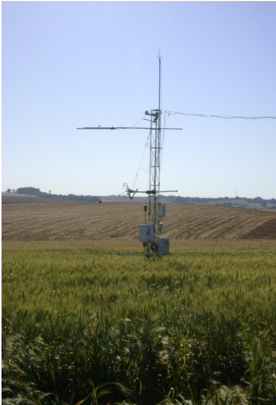
Figura 2.4 – Torre micrometeorológica instalada no sistema de plantio direto em Cruz Alta/RS.
