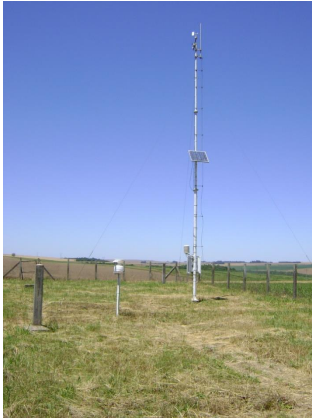
Figura 2.7 - Estação meteorológica automática do INMET, em Cruz Alta/ RS.
