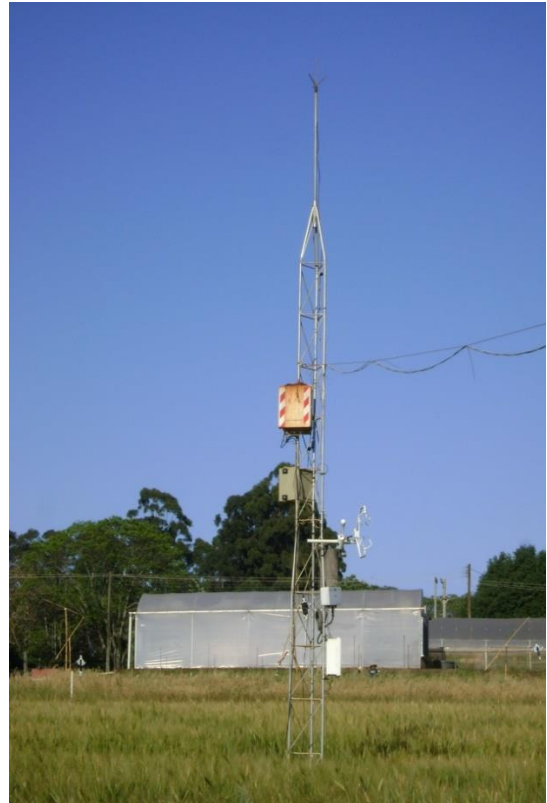
Figura 2.5 – Torre micrometeorológica instalada no sistema de plantio convencional em Cruz Alta/RS.
