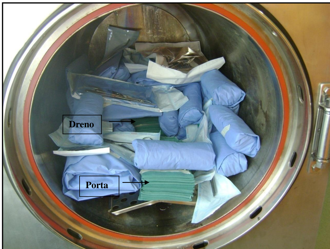
FIGURA 1 – Imagem fotográfica demonstrando o posicionamento dos pacotes de campos (setas) contendo as ampolas do teste biológico, dentro da câmara da autoclave utilizada na central de materiais do HVU – UFSM.
