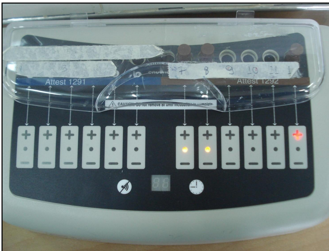
FIGURA 3 – Imagem fotográfica da incubadora de Leitura Rápida 3M Attest Modelo 290, em funcionamento. Em 7, 8, ampolas autoclavadas e em 12 a ampola controle já indicando resultado positivo.
