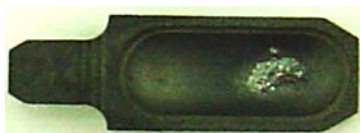
Figura 2. Plataforma de grafite com amostra de carbeto de boro fundida após ciclo de aquecimento com temperatura em 2400 °C.
