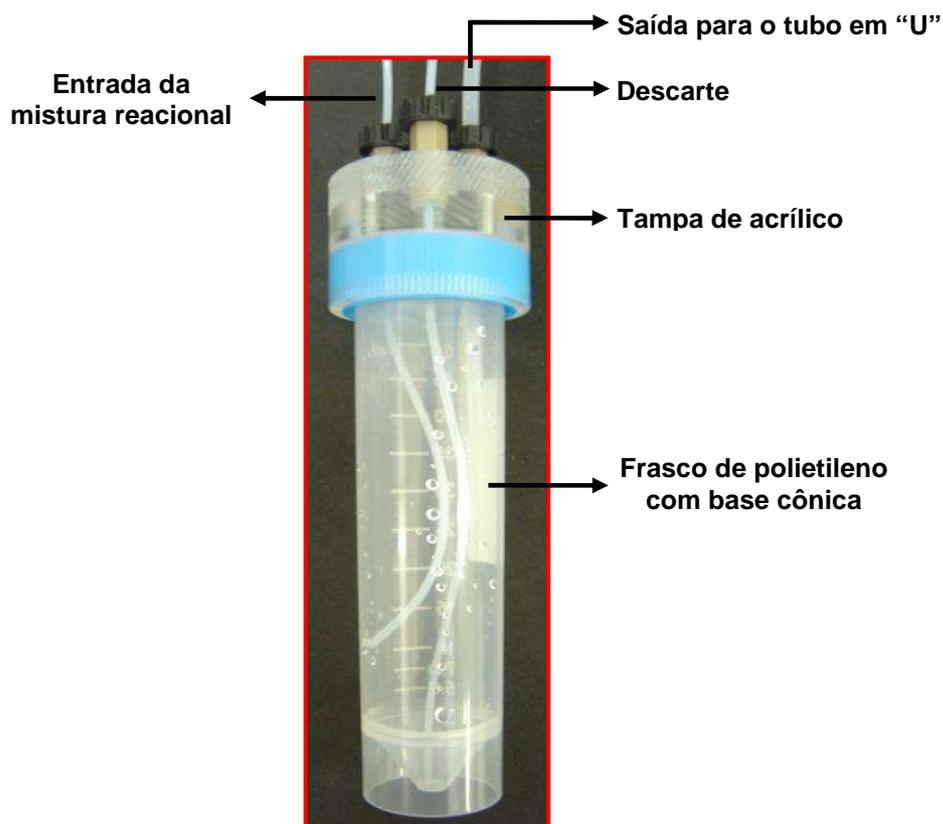
**Figura 8.** Foto do frasco de polietileno modificado utilizado como separador gás-líquido na análise de especiação por HG-CT-AAS.
