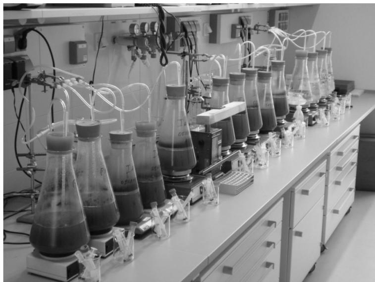
Figura 7- *Zahn Wellens Test* sendo aplicado para avaliar a biodegradação de DEX.
