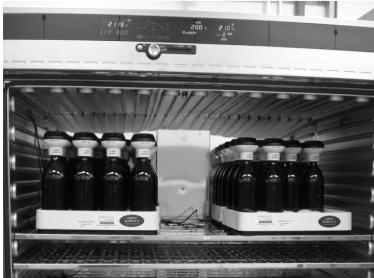
Figura 6- *Manometric Respirometry Test* usado para estimar a pronta biodegradação de DEX no ambiente.
