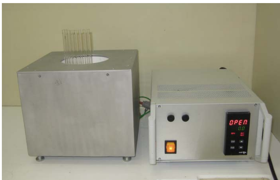
Figura 17 – Forno com controlador de temperatura utilizado para a pirólise.
