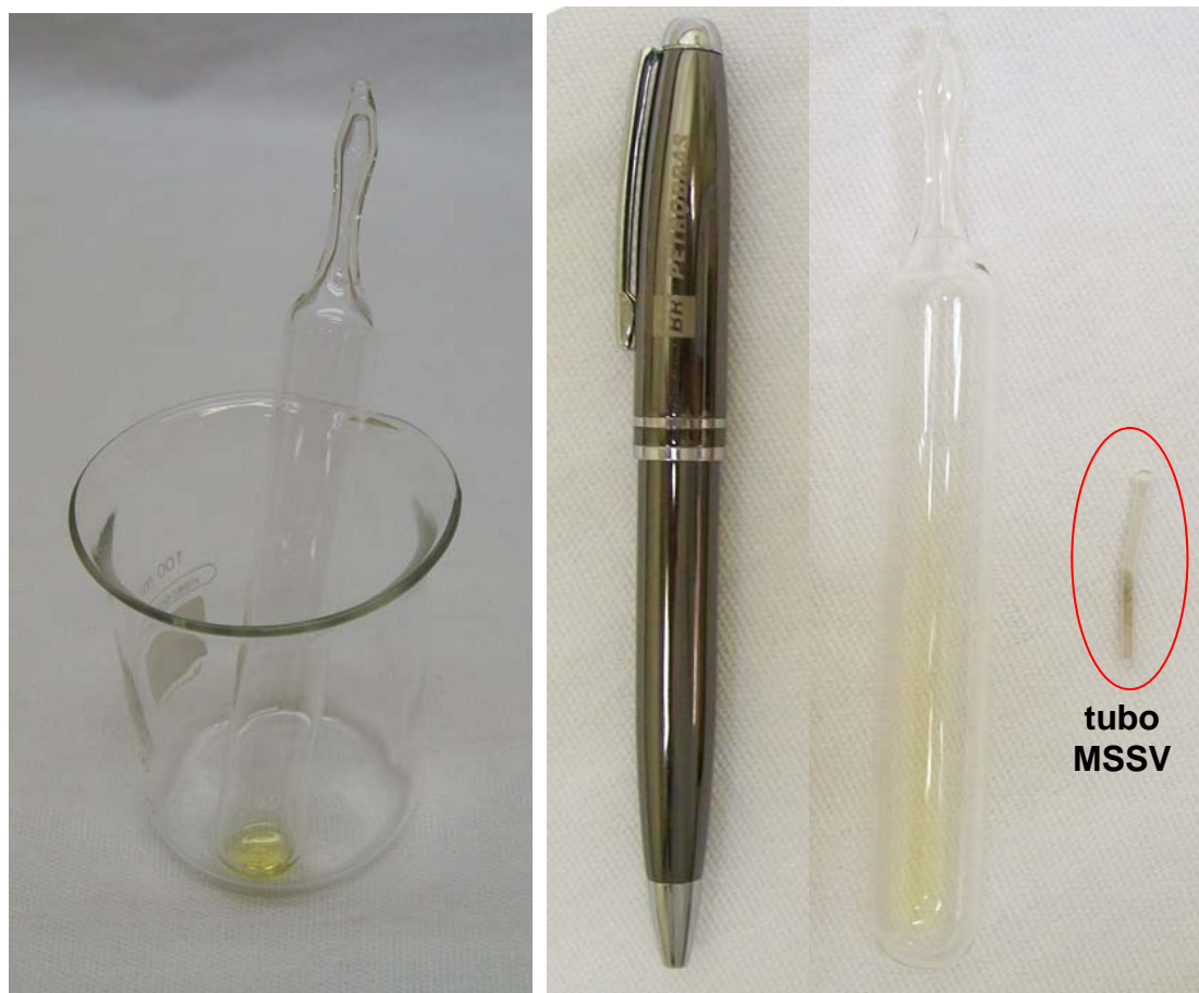
Figura 52 – Ampola de vidro com 500 µL de n -octano após a pirólise a 470°C por 1 h.
