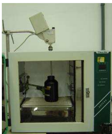
Figura 19. Sistema de homogeneização das amostras dos petróleos.
