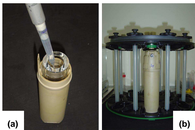
Figura 22. (a) Adição de água (b) vista do rotor com o frasco.
