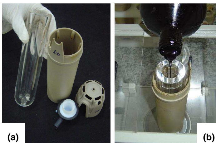
Figura 21. (a) Vista do conjunto: frasco de quartzo, capa de proteção, tampa, capa da tampa (b) Adição de petróleo no frasco.
