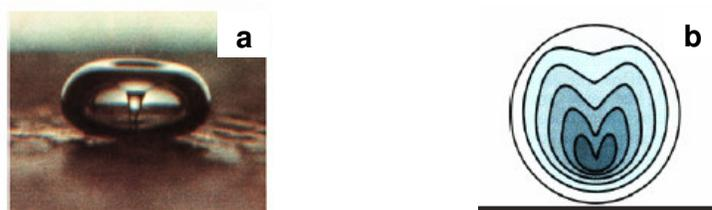
**Figura 7.** Micrografia da (a) implosão de uma bolha de cavitação próxima a uma superfície sólida e (b) evolução da cavidade formando o jato (adaptado de Suslick<sup>98</sup>).
