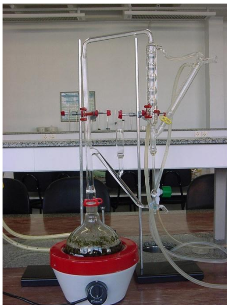
Figura 13. Aparelho de Clevenger modificado, utilizado na extração dos óleos essenciais.
