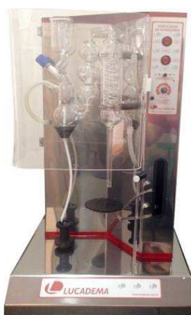
Figura 9. Sistema de destilação utilizado para a determinação de N pelo método micro-Kjeldahl.
