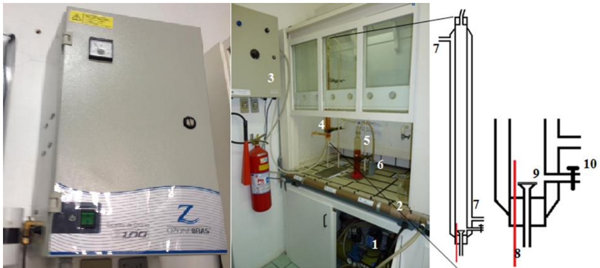
Figura 16 – Sistema de ozonização empregado na degradação de HPAs.
