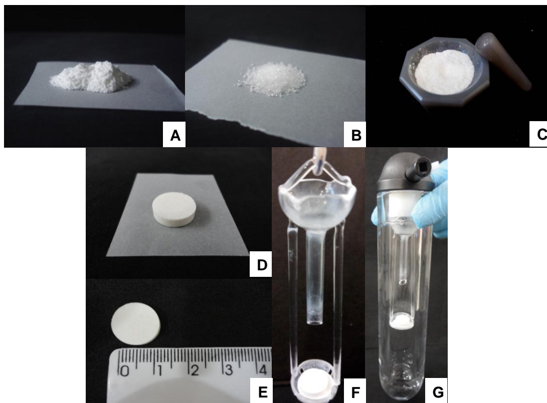
Figura 2. Etapas do preparo das amostras para decomposição por combustão iniciada por micro-ondas: (A) fármaco, (B) \text{NH}_4\text{Cl} , (C) homogeneização da mistura do fármaco mais \text{NH}_4\text{Cl} em gral (D) e (E) comprimidos, (F) suporte de quartzo com comprimido alocado sobre o papel filtro umedecido com \text{NH}_4\text{NO}_3 e (G) suporte de quartzo inserido no frasco de decomposição contendo solução absorvedora.
