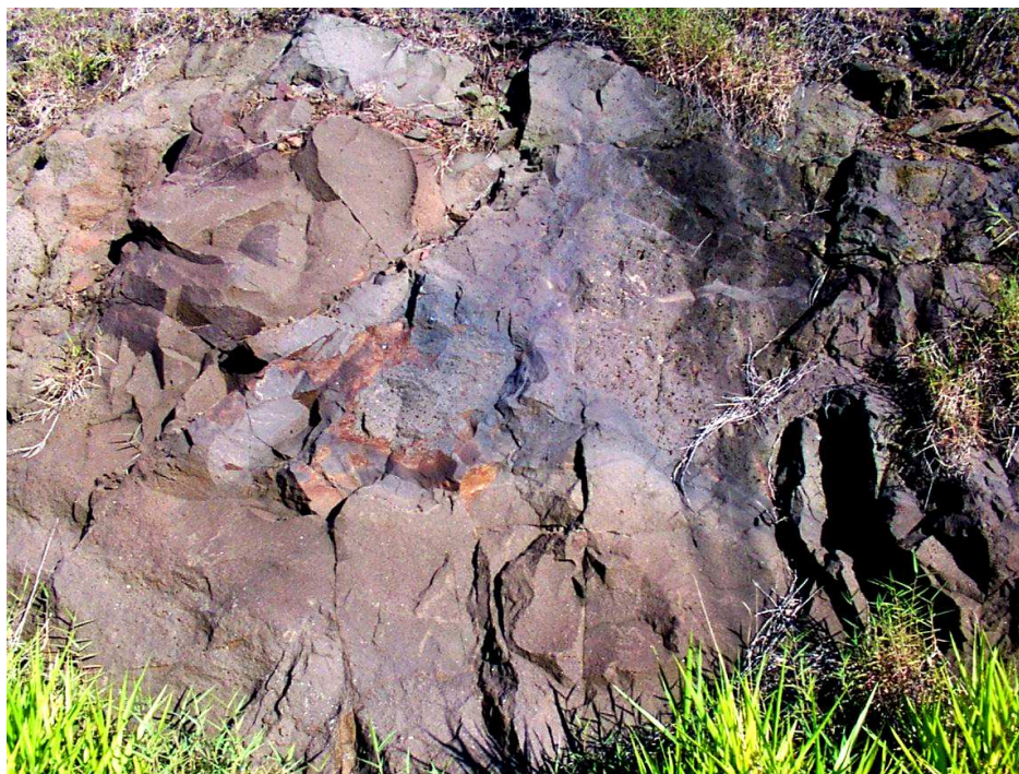
Figura 04 – Ilustração da estrutura rochosa (rocha vulcânica) maciça com baixa densidade fraturas em Campina das Missões
