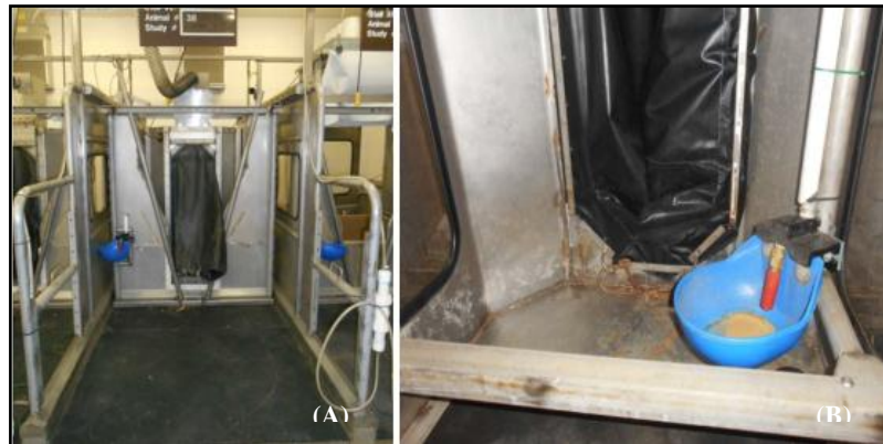
Figura 6 – A) Foto demonstrativa de uma das câmara de calorimetria indireta estilo câmara respiratória; B) Vista interna da parte frontal da head-box com bebedouro.
