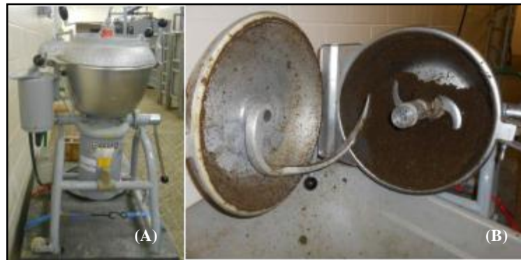
Figura 4 – Misturador automático utilizado para homogeneizar as amostras de fezes ao final de cada período experimental; A) Vista lateral do misturador; B) Interior do misturador com amostra de fezes.
