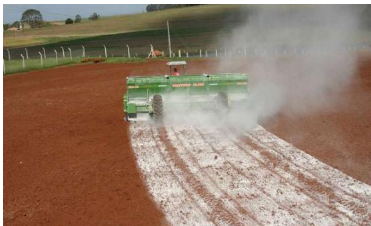
Figura 4 - Sistema de distribuição gravitacional
