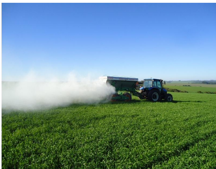
Figura 13 - Efeito do vento na aplicação do calcário
