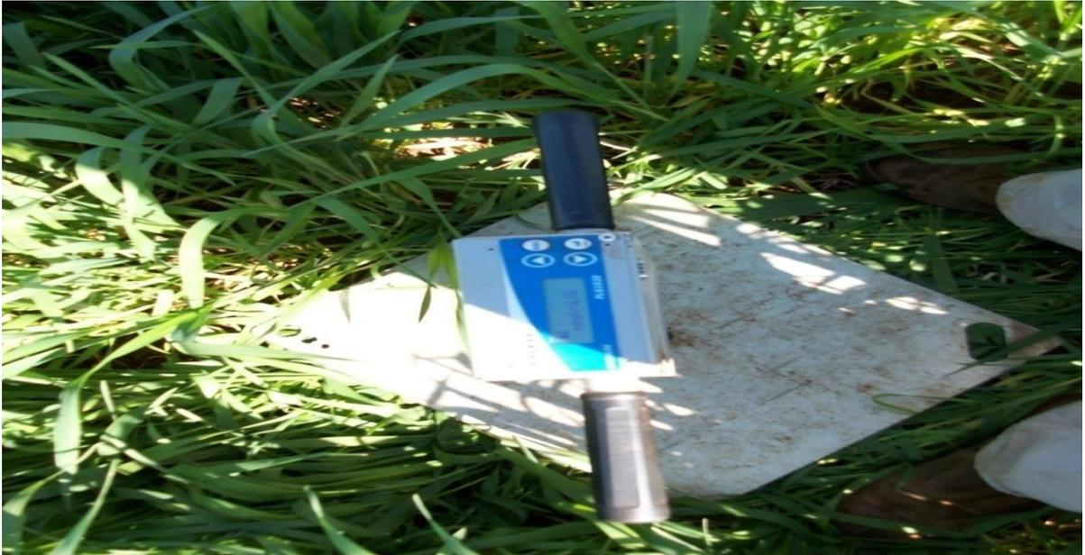
Figura 5 – Avaliação da compactação do solo com o equipamento PenetroLog.
