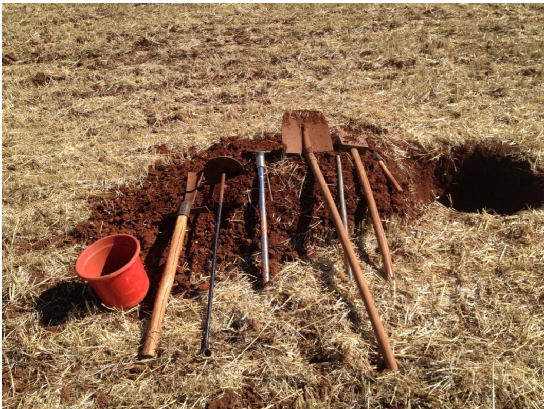
Figura 10 – Amostradores de solo e equipamentos para abertura das trincheiras e remoção dos resíduos
