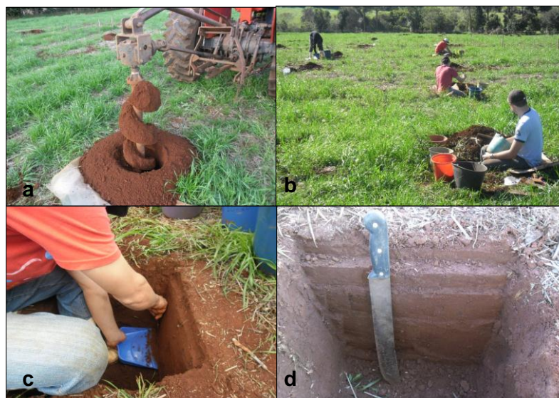
Figura 3 – Abertura das trincheiras com trado de rosca (a) para coleta manual de solo (b; c) em camadas do perfil (e) de cada sub-subparcela, Jaboticaba – RS, 2014.
