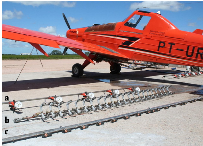
Figura 1 Avião Ipanema e equipamentos utilizados no experimento: (a) Atomizador rotativo de discos, (b) Sistema eletrostático e (c) bicos hidráulicos.
