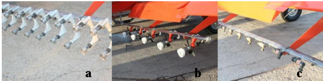
Figura 2 Equipamentos para aplicação aérea. (a) Sistema eletrostático, (b) Atomizador rotativo de disco, (c) Bico hidráulico.
