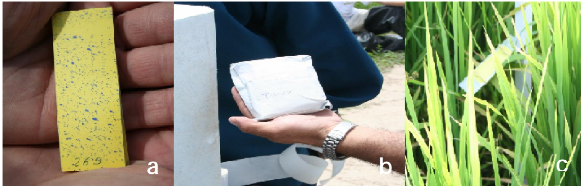
Figura 3. papéis hidrossensíveis recém coletados a campo (a), amostras embaladas (b) e suporte com papel a campo(c).
