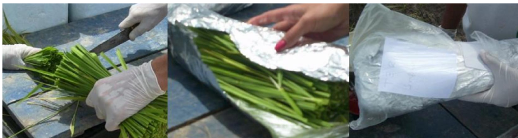
Figura 4 Procedimento de preservação da amostra para análise cromatográfica. (a) divisão das plantas em inferior e superior, (b) acondicionamento em papel alumínio, (c) amostra identificada para acondicionar em gelo seco.
