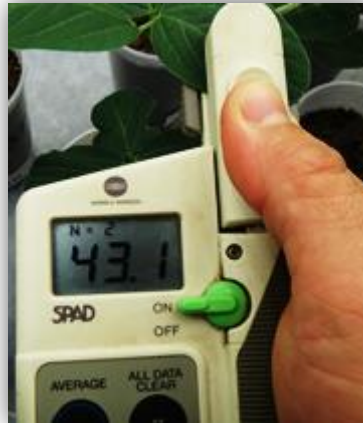
Figura 3 – Clorofilômetro Spad 502® (Minolta Camera Co. Ltda.) utilizado para determinar o teor relativo de clorofila. Santa Maria – RS/2013.
