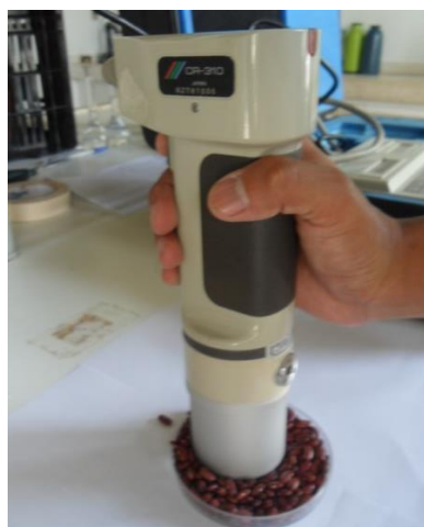
Figura 2 - Colorímetro usado para a determinação da coloração do tegumento dos grãos.
