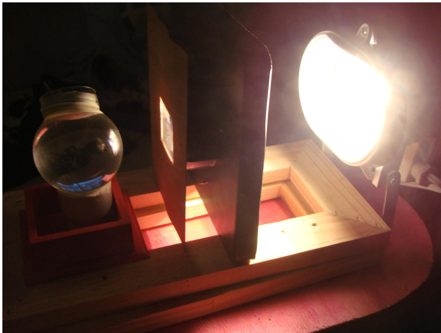
Figura 58 – Processo de construção de um projetor artesanal, 2012, lentes de lupa, transparência com impressão color laser, madeira, lâmpada alógena, instalação elétrica
