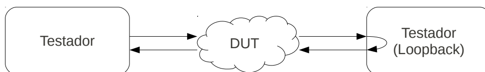
Figura 11: Cenário de testes com loopback . Figura adaptada de (BRADNER; MCQUAID, 1999)
