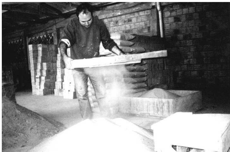
Figura 15– A areia sendo peneirada - Fábrica Bevillaqua & Luchese.
