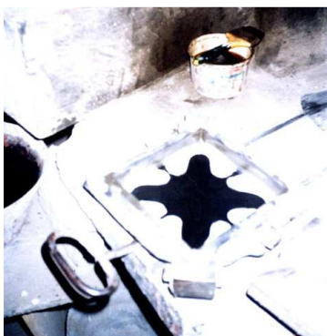
Figura 19 – A tinta dentro da forma sem o molde.
