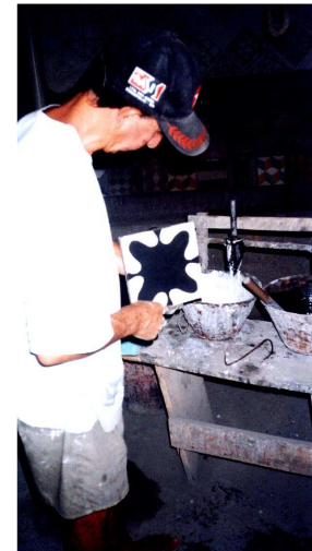
Figura 21 – Retirando o ladrilho.
