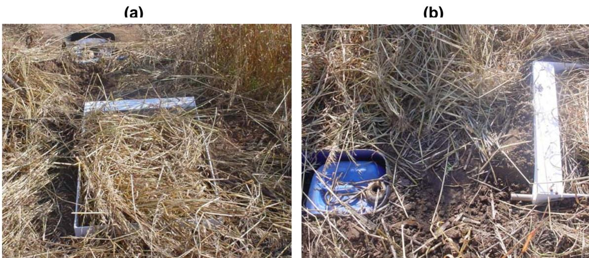
Figura 7 - Coletor da solução escoada superficialmente no solo (a) e recipiente de armazenagem da solução escoada (b).
