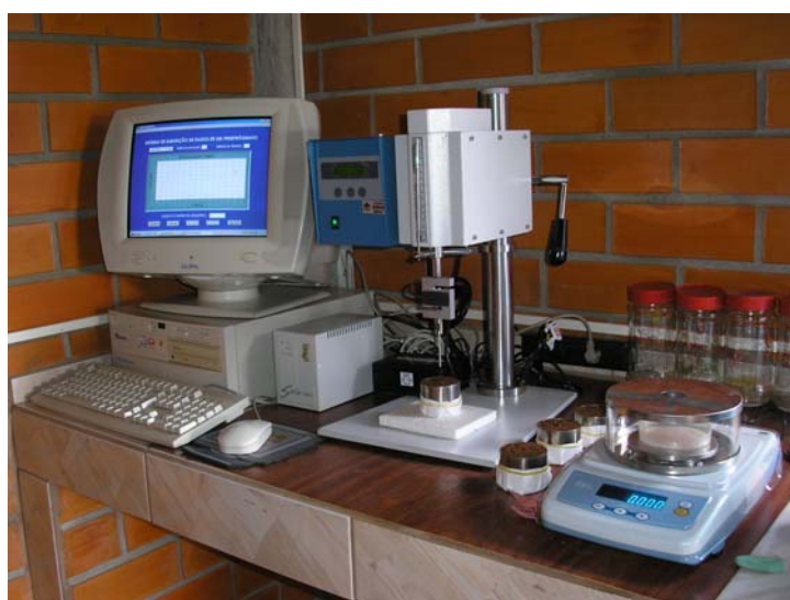
Apêndice D – Penetrômetro de bancada. Marca Marconi. Epagri – Campos Novos – SC. Foto: Veiga (2006).
