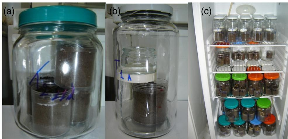
Figura 3 - Vista dos frascos de vidro utilizados na avaliação da dinâmica do N (a) da mineralização do C (b) e dos fracos acondicionados na incubadora (c).
