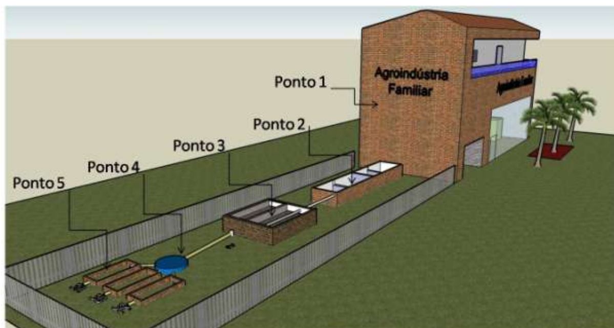
APÊNDICE E - Esquema ilustrativo da estrutura de tratamento de resíduos de agroindústria de laticínios. Ponto 1 – Agroindústria; Ponto 2 – tanque de decantação e deposição; Ponto 3 – tanque de retenção de gordura; Ponto 4 – caixa de distribuição; Ponto 5 – tanque de tratamento por zona de raízes.
