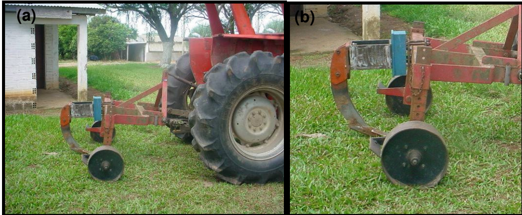
FIGURA 16 – Anel octogonal acoplado à haste escarificadora e essa ao trator (a). Anel octogonal acoplado à haste escarificadora (b).
