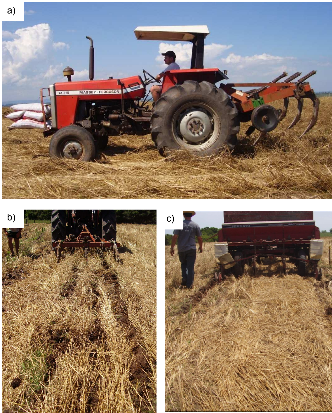
Figura 2. Trator com equipamento escarificador (a); Mobilização do solo feita pelo implemento escarificador com 3 hastes (b); Semeadura da cultura da melancia (c).
