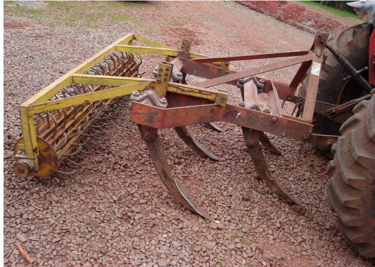
Figura 4 – Escarificador com rolo destorroador utilizado para descompactação mecânica do solo em área manejada sob sistema plantio direto.
