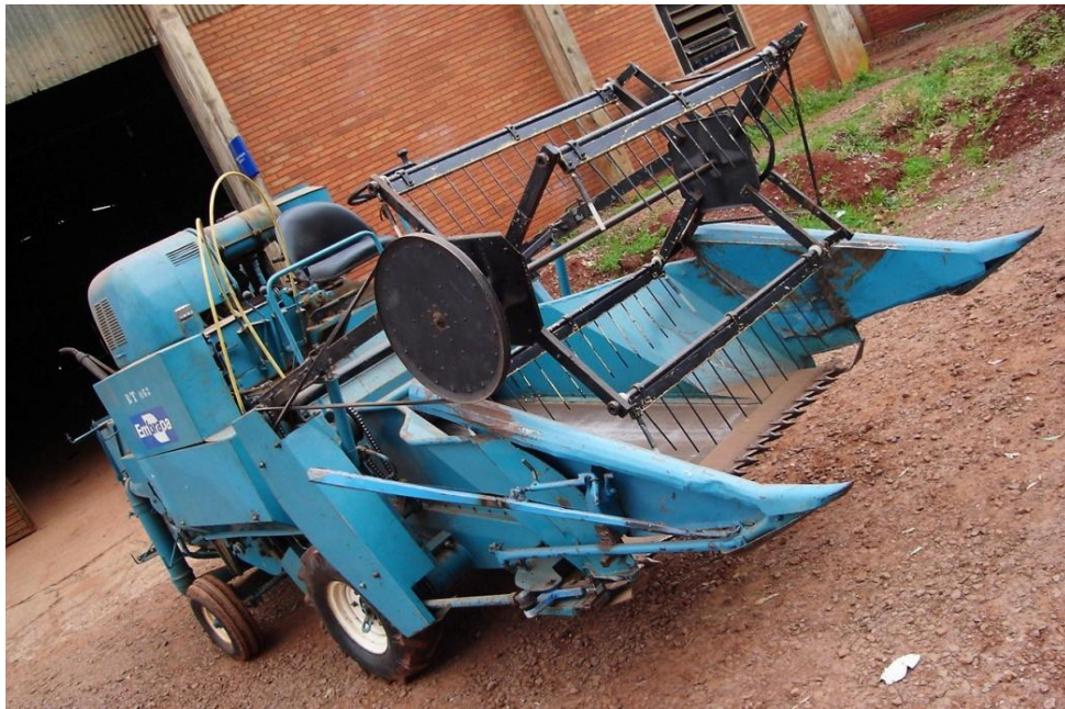
Figura 8 - Colhedora de parcelas da marca Wintersteiger utilizada para colheita mecânica da soja na safra agrícola 2008/2009.
