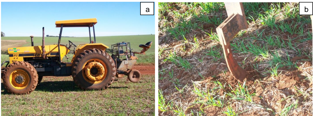
Figura 7 - Trator da marca Valmet com dupla tração, utilizado na avaliação da força exercida na barra de tração de trator agrícola (a) e detalhe da haste sulcadora tracionada pelo trator (b).
