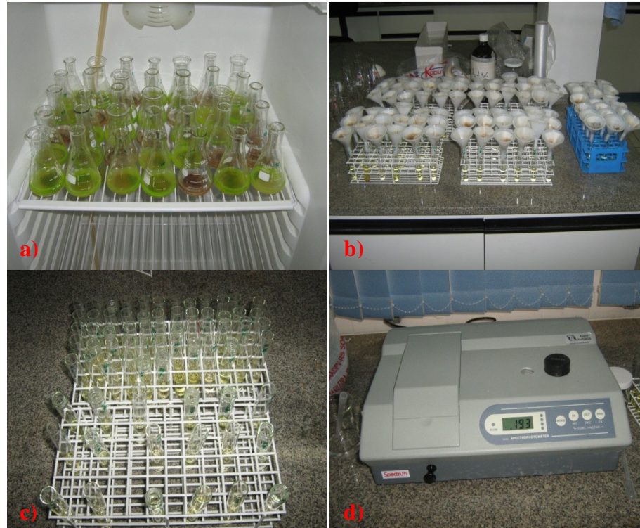
Figura 4.1 - Determinação da atividade enzimática do solo: a) Incubação de amostras para a enzima; b) Etapa de filtragem; c) Extrato após filtragem; d) Espectrofotômetro para medida da absorbância.
