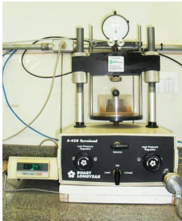
Figura 3 - Consolidômetro, modelo S-450 Terraload (DurhamGeo-Interprises) com indicador digital da carga aplicada e leitura analógica da deformação da amostra.
