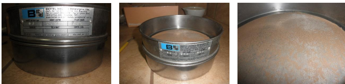
Figura 10: Peneiramento das amostras de sedimento em suspensão.
