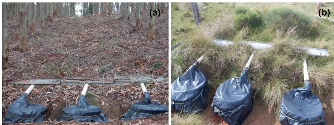
Figura 29 - Parcelas para a quantificação das perdas de água e de solo no povoamento de eucalipto da BE (a) e no campo nativo da BC (b), São Gabriel-RS.
