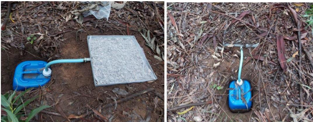
Figura 23 - Calhas para a quantificação da interceptação da água pela serapilheira nos povoamentos de eucalipto da bacia com eucalipto, São Gabriel-RS.
