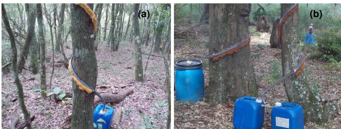
Figura 22 - Canaletas coletoras na forma de espiral para quantificação do volume de água que escoo pelo tronco das árvores na área de mata nativa da BE (a) e nos capões de eucalipto da BC (b), São Gabriel-RS.
