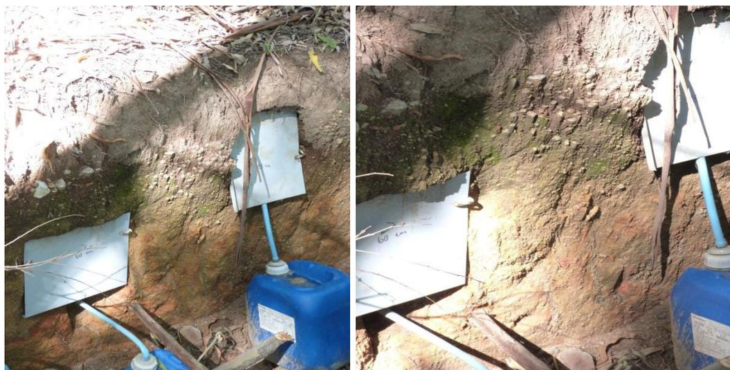
Figura 24 - Calhas para a quantificação da água percolada livremente no solo, aos 15 cm e aos 60 cm de profundidade, nas BE e na BC, São Gabriel-RS.
