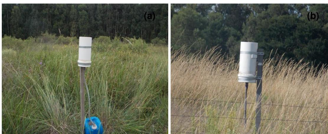
Figura 16 - Pluviômetro acoplado a um recipiente de armazenamento para quantificar o volume total precipitado na bacia com eucalipto (a) e na bacia com campo nativo e pastagem manejada (b), São Gabriel-RS.
