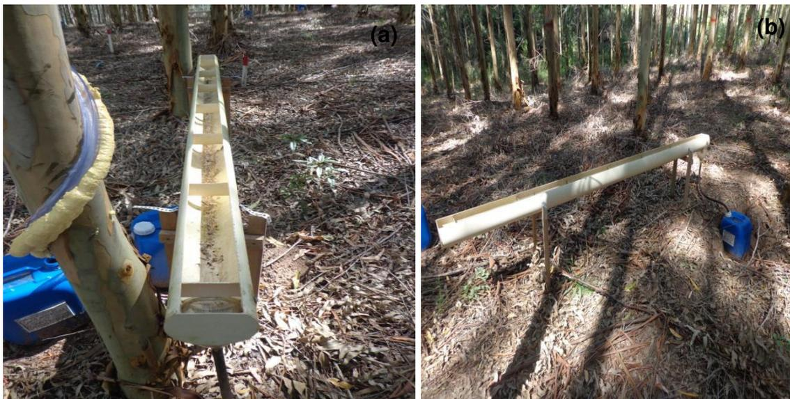
Figura 17 - Interceptômetros lineares para a quantificação da precipitação interna na linha (a) e na entrelinha de plantio (b) no povoamento de eucalipto da BE, São Gabriel-RS.
