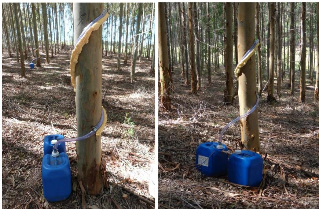
Figura 21 - Canaletas coletoras na forma de espiral para a quantificação do volume de água que escoar pelo tronco das árvores, nos povoamentos de eucalipto da BE, São Gabriel-RS.
