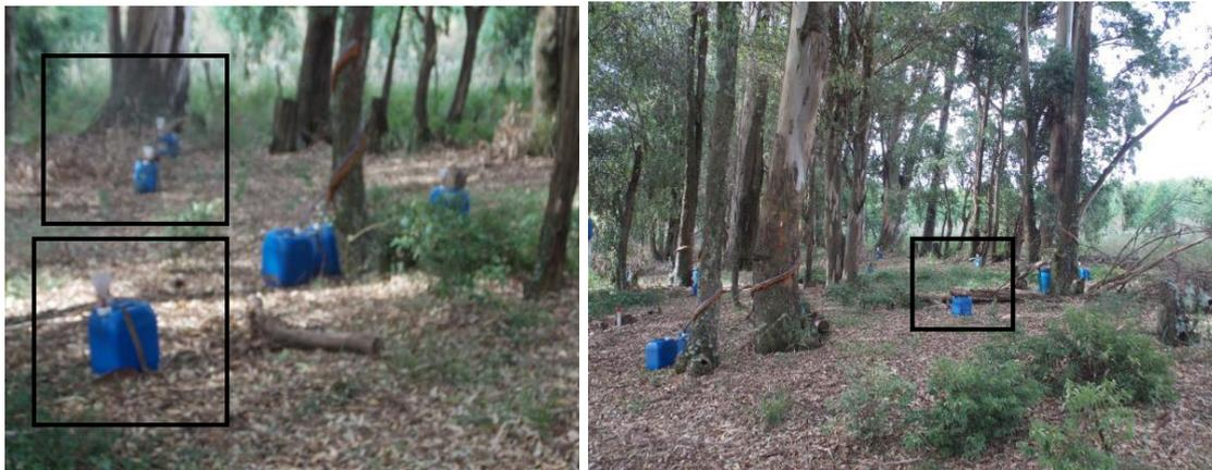
Figura 19 - Interceptômetros para a quantificação da precipitação interna nos capões de eucalipto da bacia com campo nativo e pastagem manejada, São Gabriel-RS.
