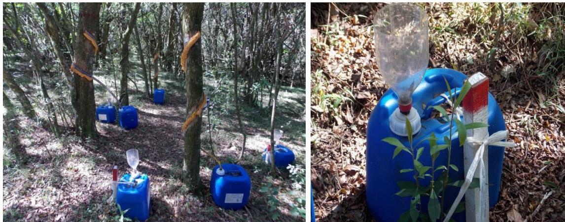
Figura 18 - Interceptômetros para a quantificação da precipitação interna nas áreas de mata nativa das BC e BE, São Gabriel-RS.
