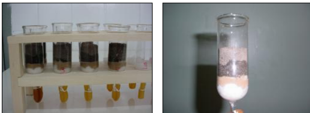
Anexo 05. Suportes de madeira e os tubos contendo os solos para incubação anaeróbia.
