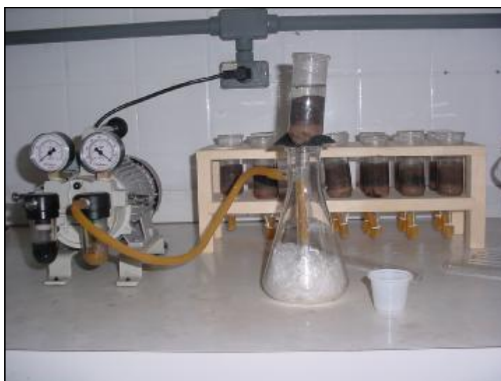
Anexo 06. Aparato utilizado na coleta da solução de alagamento dos solos incubados anaerobiamente por 24 semanas.
