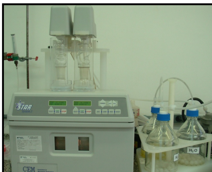
Figura 2 – Forno de micro-ondas focalizadas, CEM, Star System 2, equipado com frasco de vidro utilizado para obtenção do extrato de própolis – Departamento de Química da UFSM. Foto: Acervo pessoal do autor (2011).
