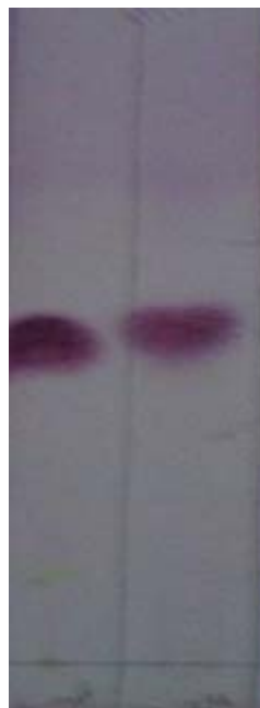
FIGURA 44 – Cromatograma da mistura Ab1 e frações 22 a 24 (Ab3) da coluna 5 com observação sob luz visível. Sistema eluente: \text{CHCl}_3 , revelador: anisaldeído-sulfúrico e aquecimento a 100^\circ\text{C} .
