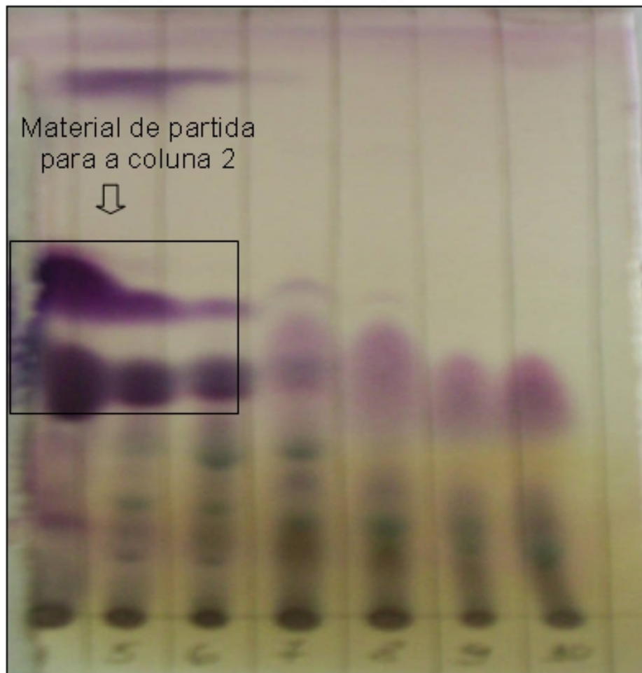
FIGURA 31 – Cromatograma das frações 4 a 10 da coluna 1 com observação sob luz visível. Sistema eluente: hexano:acetona (9:1)-migrado 4 vezes, revelador: anisaldeído-sulfúrico e aquecimento a 100°C.
