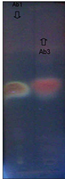
FIGURA 45 – Cromatograma da mistura Ab1e 22 a 24 (Ab3) da coluna 5 com observação sob luz ultravioleta. Sistema eluente: \text{CHCl}_3 , revelador: anisaldeído-sulfúrico e aquecimento a 100^\circ\text{C} .
