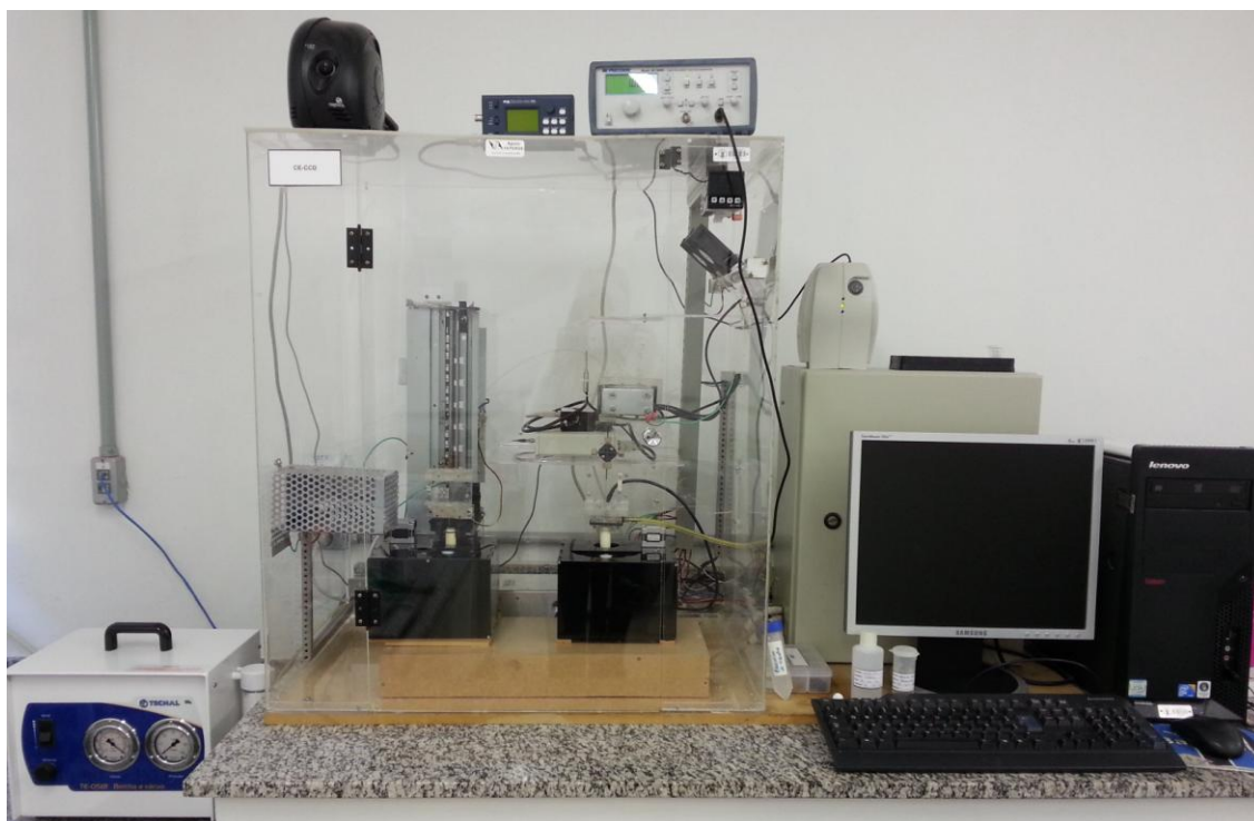
Figura 19 – Foto do equipamento de CE construído em laboratório.
