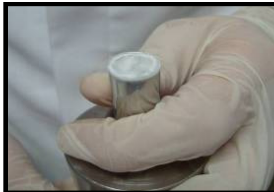
Figura 22 – Mistura após ser levada a prensa hidráulica
