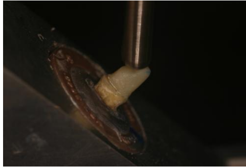
Fig. 6: Dispositivo montado em 45° em relação longo eixo do dente para o teste de resistência à fratura.
