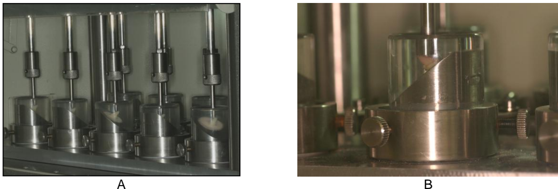
Fig. 4: A) Espécimes na máquina de ciclagem mecânica (10 estações); B) Atuador de 2,5 mm de diâmetro agindo nos espécimes.
