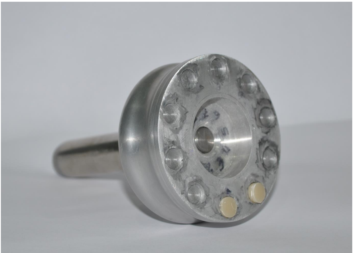
Figura 1 – Fotografia do dispositivo metálico para fixação dos espécimes de resina composta para padronização na politriz
