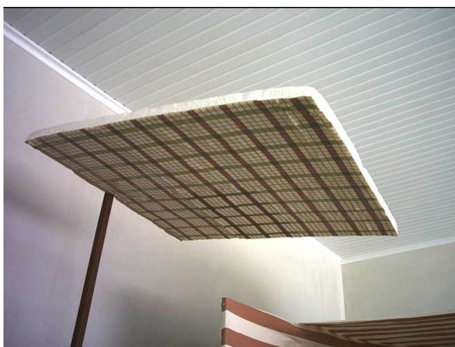
FIGURA 8 – Papel com escala em centímetros fixada acima da cabine, a fim de anotar o maior deslocamento em centímetros para realização cálculo da FLP.
