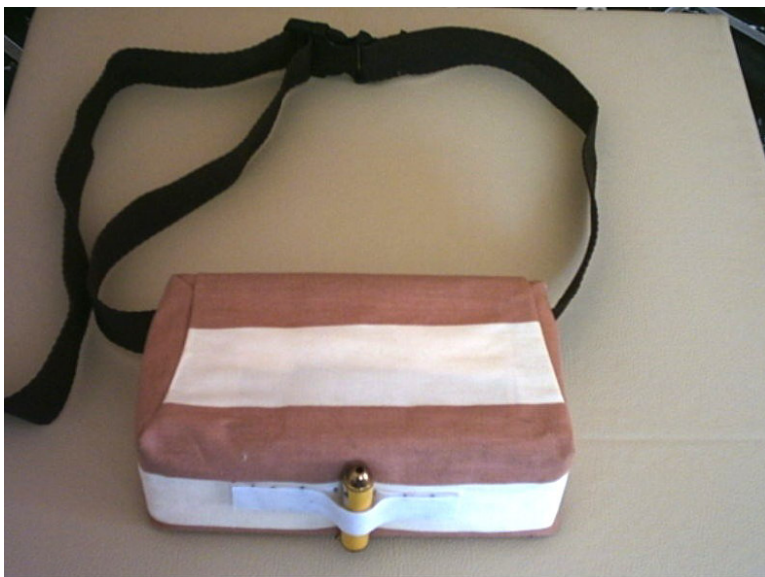
FIGURA 7 – Cinto confeccionado em tecido de Nylon e isopor, com encaixe nas extremidades ajustáveis ao nível da cintura do participante, com caneta de feixe de laser acoplado.
