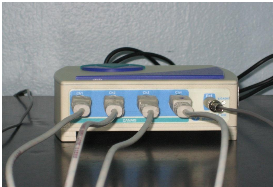
Figura 3 – Eletromiógrafo de superfície (Miotool 400)
