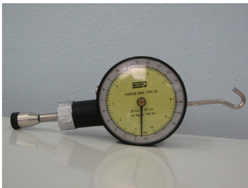
Figura 2 – Dinamômetro Force Dial™ FDK/FDN
