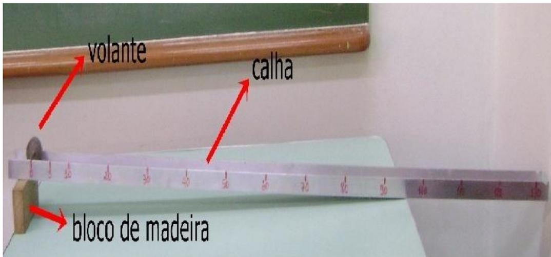
Figura 7 - Aparato experimental do MRUV: volante, calha e suporte.
