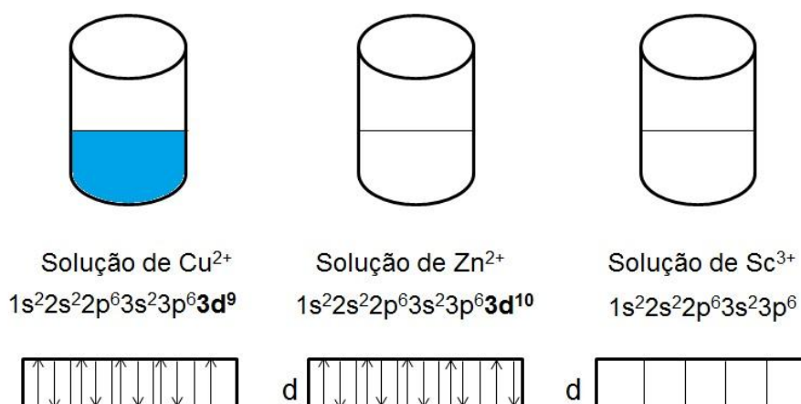
Figura 11 - Representação do \text{Cu}^{2+} , \text{Zn}^{2+} e \text{Sc}^{3+} , suas configurações eletrônicas e a distribuição dos elétrons d
