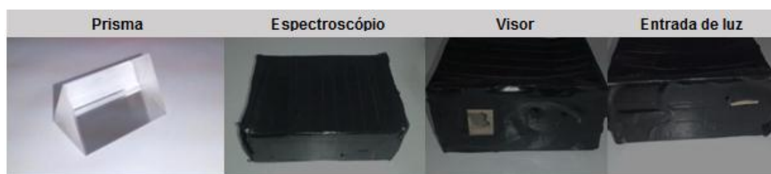
Figura 29 - Prisma de vidro óptico e espectroscópio caseiro
