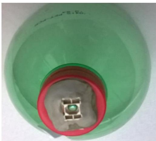
**Figura 5: Microscópio de garrafa pet pronto. Criada pela autora.**
